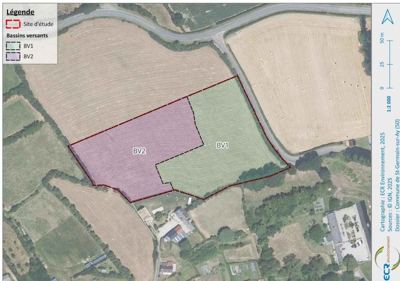
Figure 15 : Bassins versants considérés pour la gestion des eaux pluviales
